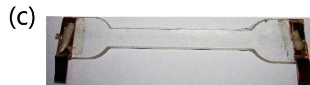
(a) 单丝模具 (b) 单丝样品示意图 (c) 单丝样品实物图
